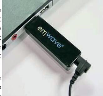
Le câble du capteur de pulsations doit être bien inséré dans le module d'enregistrement USB, c'est-à-dire que la fiche du capteur doit être complètement entrée dans le module. Si le voyant ne s'allume pas, cela signifie que le module n'est pas reconnu. Consultez le menu d'aide dans ce cas.
